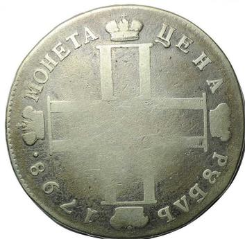
Монета исполнена по технологии чеканки. По линейным размерам деталей рельефа, характеру их проработки, качеству отделки поля, внешнему виду гурта исследованный экземпляр и привлеченные для сличения заведомо подлинные монеты идентичны. Вес, диаметр, толщина и проба металла соответствуют нормативным и находятся в допустимых ремедиумом пределах.
